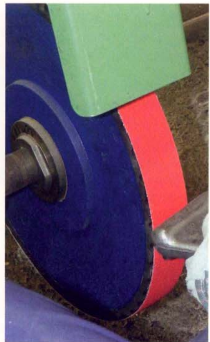
Bild 1: Gussputzen durch Bandschleifen.
