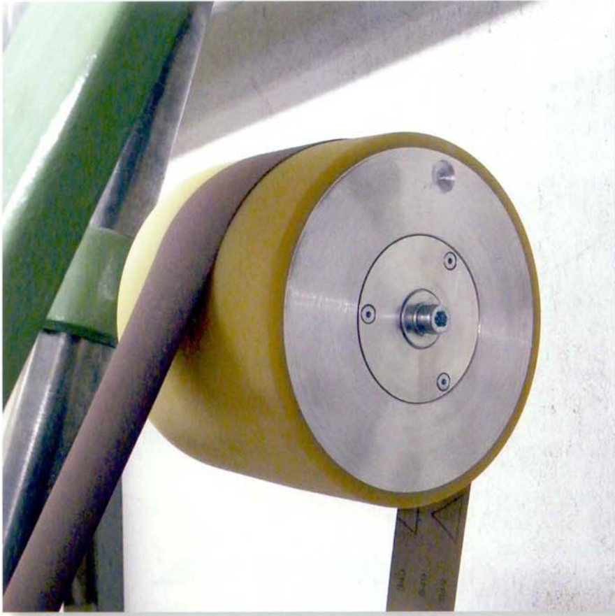
Bild 1: Umlenkrolle im Einsatz
